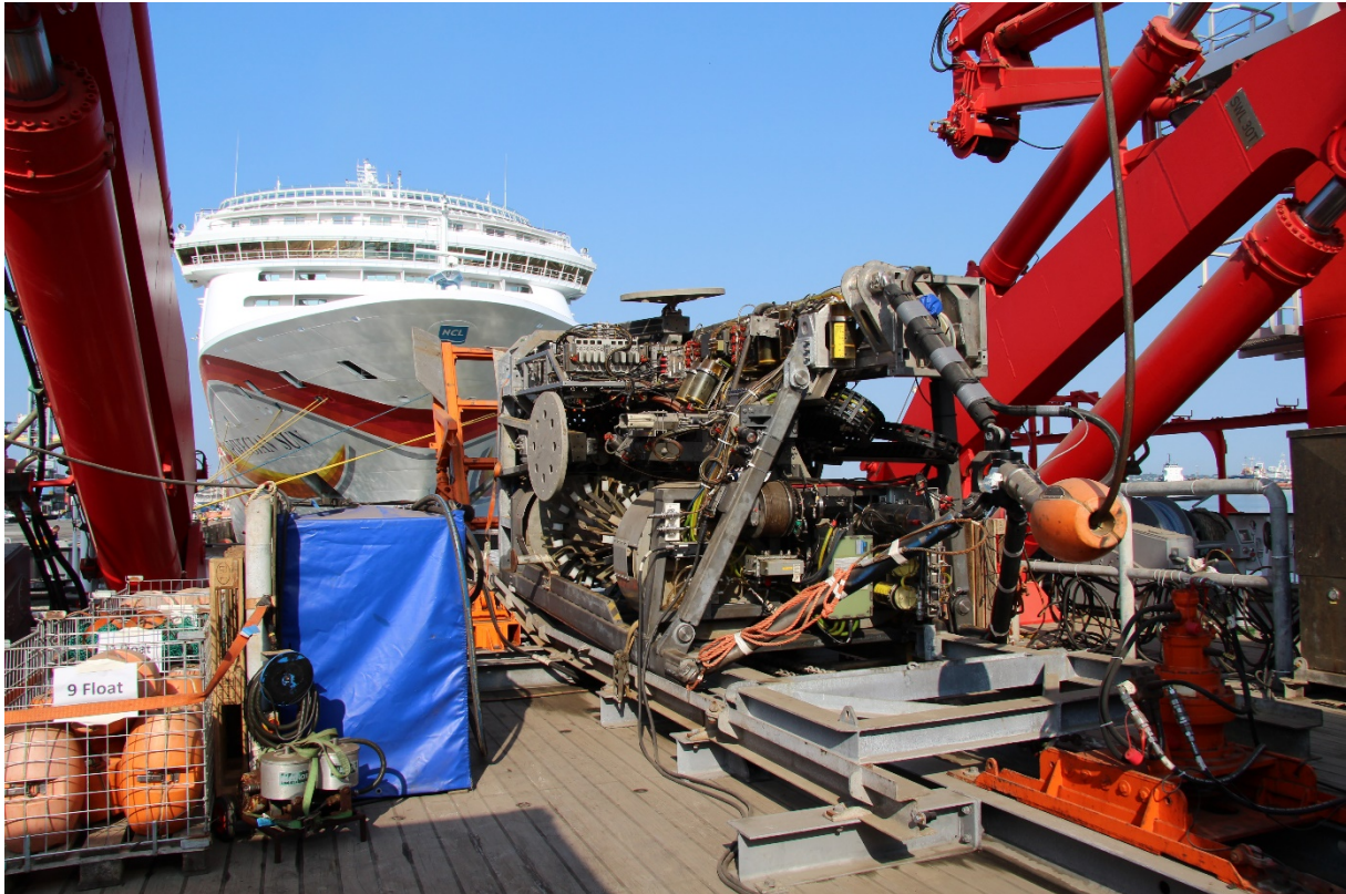
Abbildung 2: Aufbau des MeBo70 Meeresbodenbohrgeräts auf dem Arbeitsdeck der SONNE im Hafen von Montevideo. Im Hintergrund das Kreuzfahrtschiff Norwegian Sun (Foto: Sabine Kasten).
