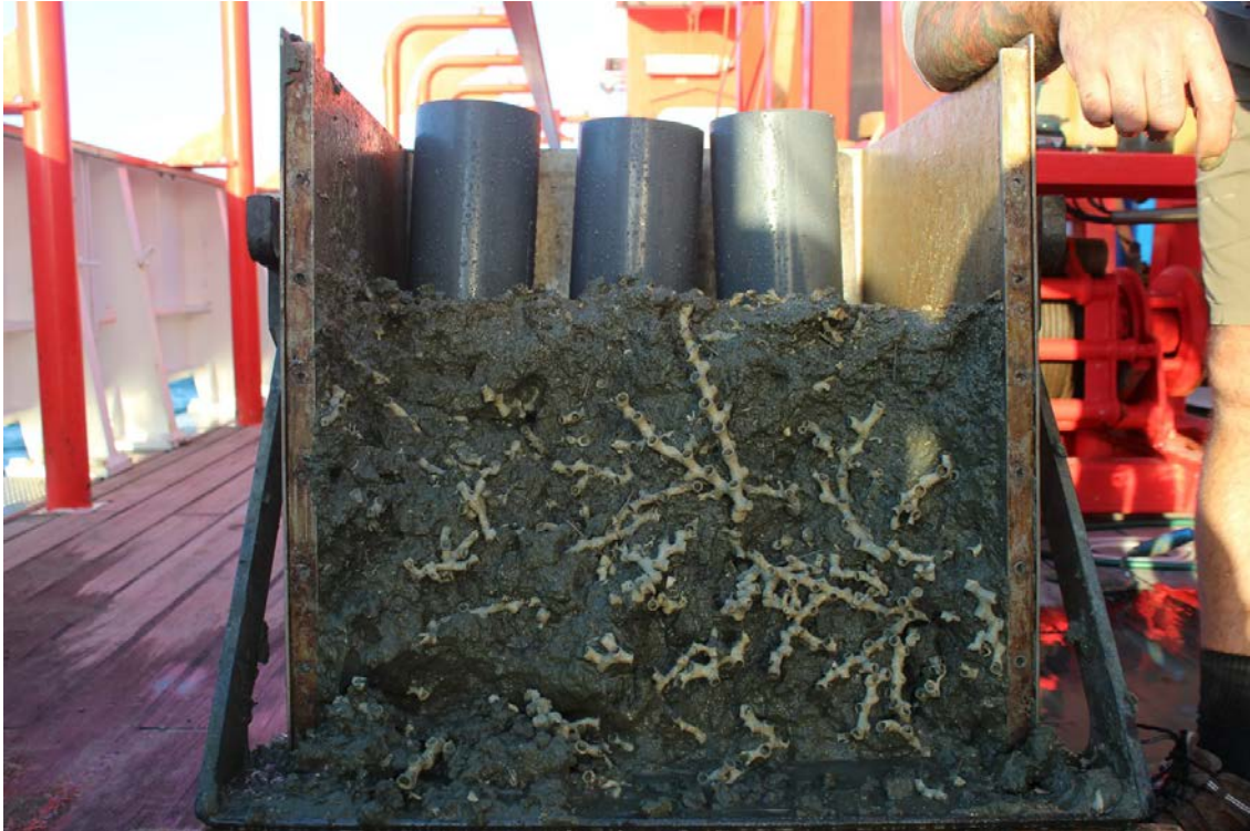
Abb. 2: Seitliche Ansicht einer geöffneten Großkastengreiferprobe, in der sich Fragmente von Kaltwasserkorallen finden (Foto: Janina Bösche).
