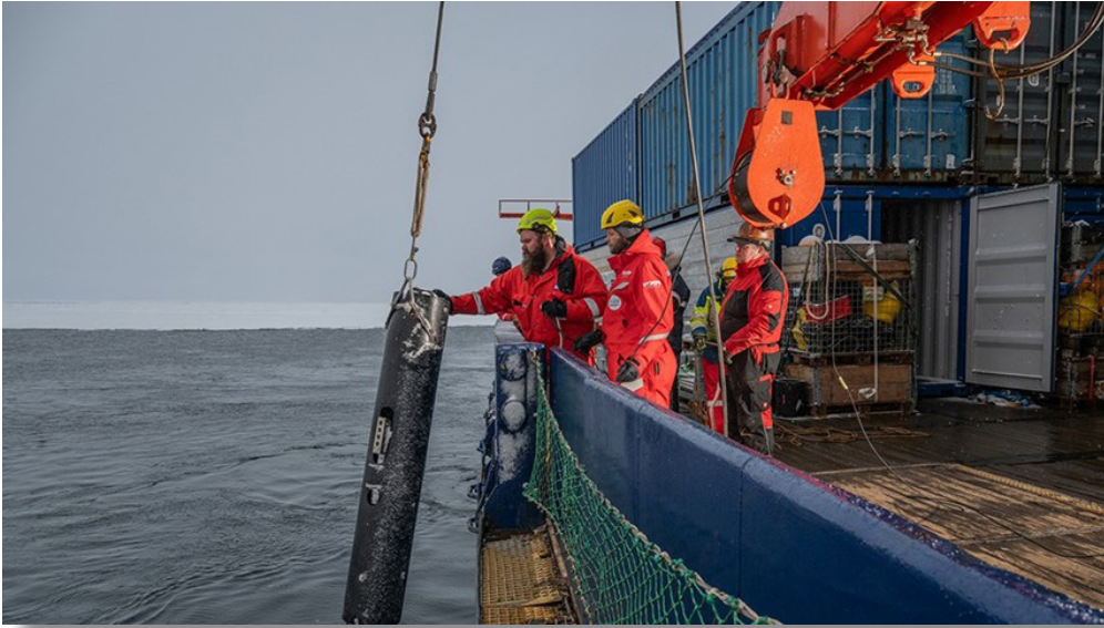
Abb.1.5: Die neue Rohr-Verankerung zur ganzjährigen hydrographischen Messung. © Esther Horvath
