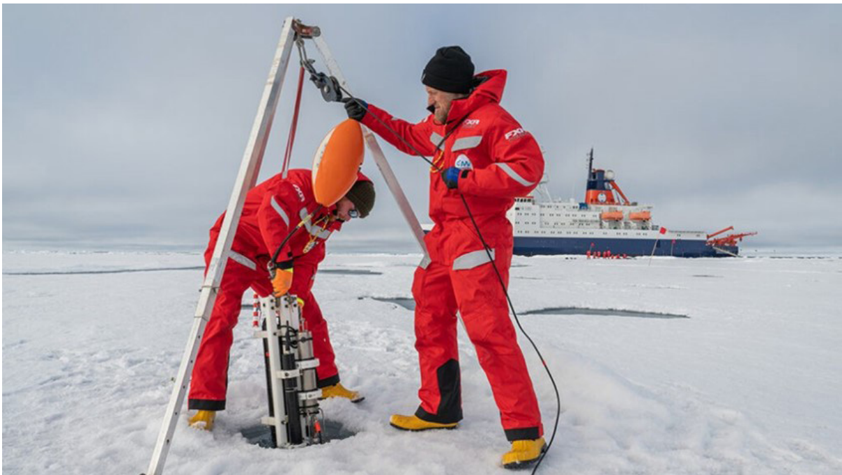
Abb. 1.4: Hydrographische Arbeiten auf dem Eis; hier Messungen mit dem Nitratsensor "Suna", der Stickstoff im Wasser misst. © Esther Horvath
