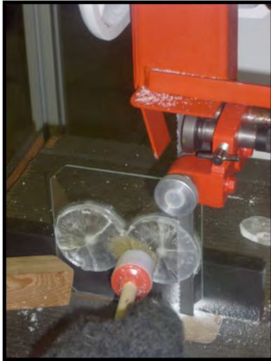
Abb. 16: Sägen einer Probe auf eine Dicke von 2 mm
