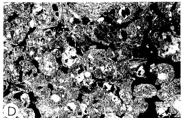
**Fig. 4:** Sample Mi.312. (A) Whole thin section, seen in plane light. (B) Sketch of thin section, dotted lines represent calcitans; rectangles show position of figures (C) and (D), bar indicates 1 cm. (C) Ausschnitt (Bildbreite 18 mm) der Aggregatstruktur, mit gekreuzten Nicols. (D) Ausschnitt (Bildbreite 5,1 mm) von Abb. C mit lattisepticem Plasmagefüge; gekreuzte Nicols, Hohlräume erscheinen schwarz.
