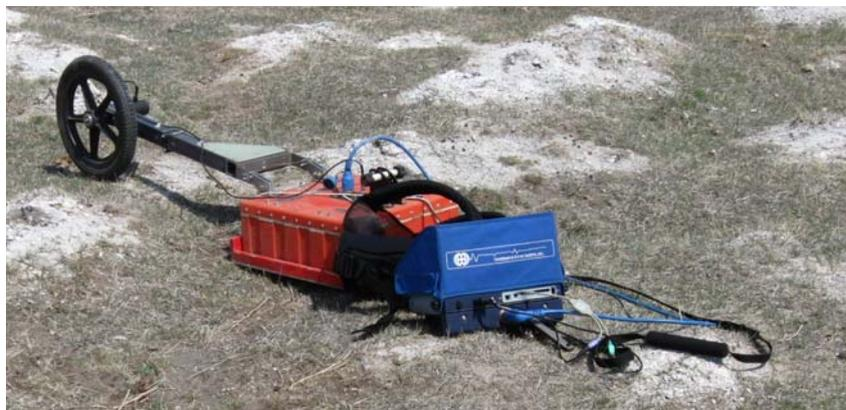
Abb. 22: GPR-Arbeitsgerät (GSSI) mit einer 270 MHz Antenne.
