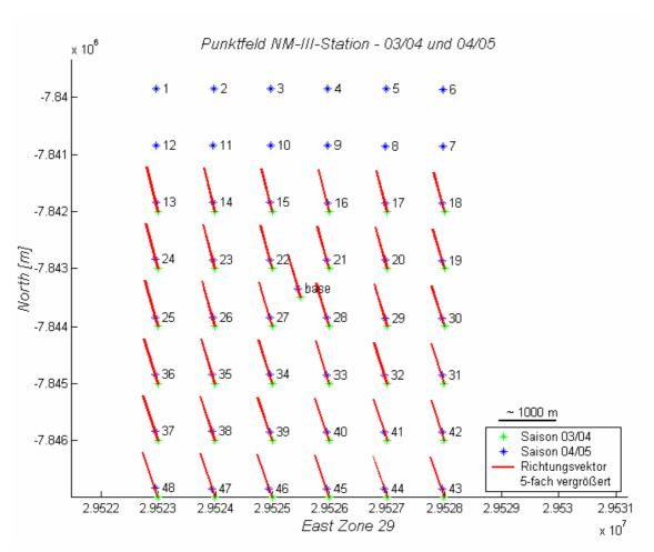
Abb. 7.1: Bewegungsvektoren im Punktfeld der NM-III-Station
