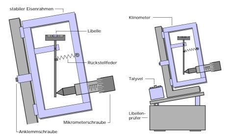
Abb. 5.1: Klinometer an Balise (links) und Versuchsaufbau zur Kalibrierung (rechts)
