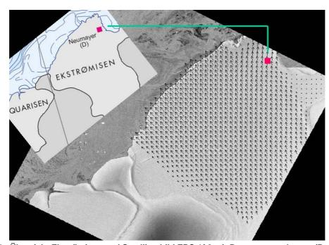
Abb. 3.1: Übersicht Ekströmisen und Satellitenbild ERS-1/-2 mit Bewegungsvektoren (Rack, 2005)
