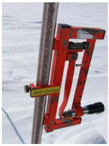
Bild 4.2: Klinometer an einer Balise
