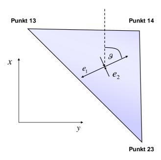
Abb. 8.1: Exemplarische Darstellung der Strain-Parameter im Dreieck der Punkte 13, 14, 23
