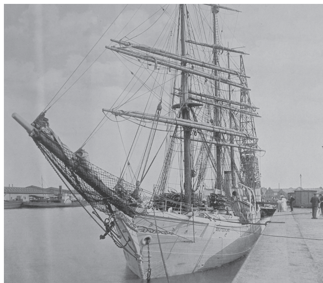
Abb 1: Die „Deutschland“ ex „Bjørn“, Expeditionsschiff der zweiten Deutschen Antarktisexpedition (2. DAE) 1911 in Bremerhaven; Länge zwischen den Loten 44,9 m (PGM 1911/1, Tafel 56).
