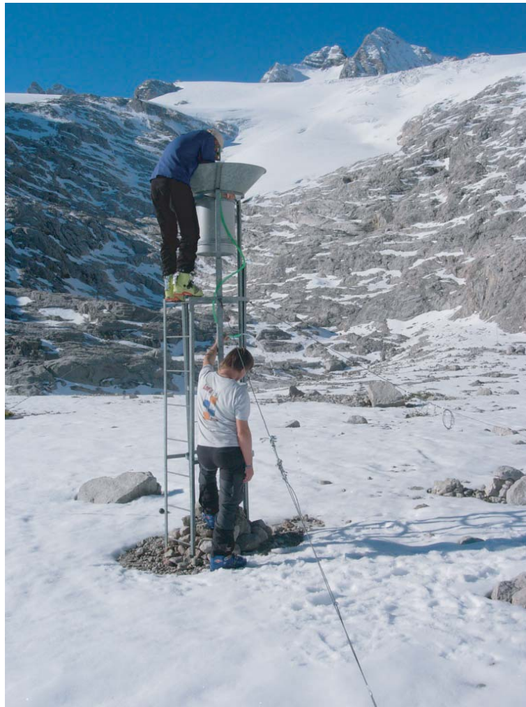
Abbildung 5.2: Ablesung des Niederschlagsmessers unterhalb der mittleren Gletscherzunge. Im Hintergrund der Hallstätter Gletscher mit dem Hohen Dachstein (2996 m).
