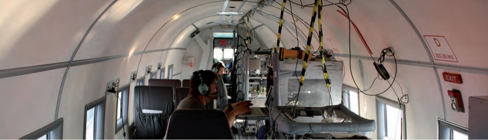
Abb. 3.3: Kabinenansicht des Flugzeugs Polar 5 während der Kampagne AIRMETH-2011. Von vorne nach hinten sieht man das MAMap Elektronik-Rack, die Basisdatenerfassung und den in-situ-Methananalysator. (Foto: Torsten Sachs, GFZ)
