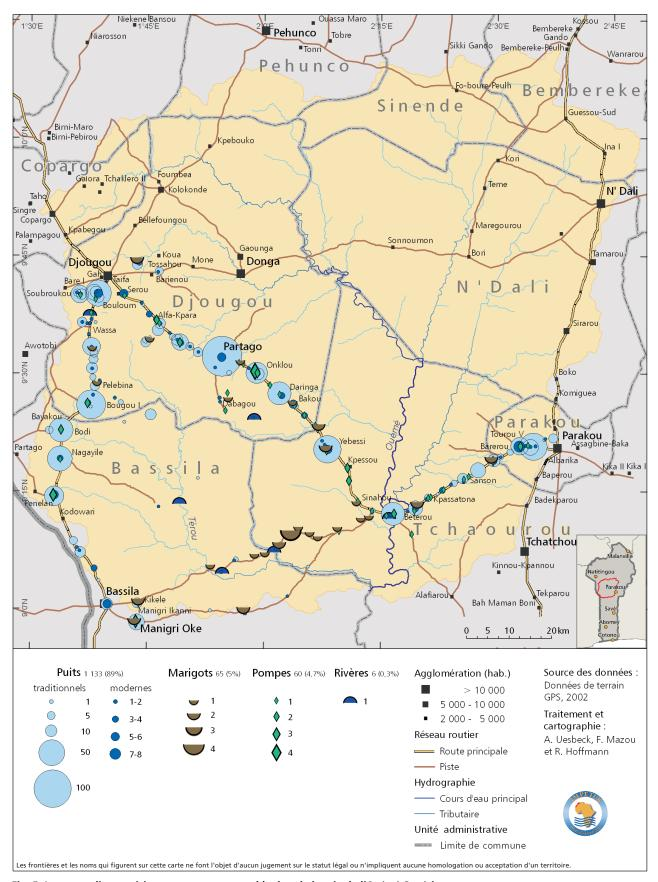
Fig. 5: Les types d'approvisionnement en eau potable dans le bassin de l'Ouémé Supérieur
