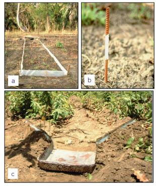
Fig. 1: Parcelle d'érosion (a), piquet d'érosion (b) et piège à sédiment (c)
