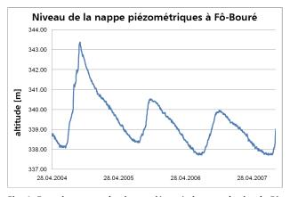
Fig. 1: Enregistrement du niveau piézométrique sur le site de Fô-Bouré, illustrant les fluctuations saisonnières de 2004 à 2007.
