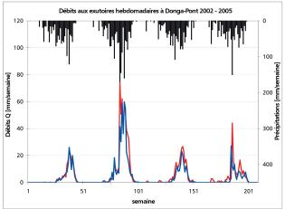
Fig. 3: Validation du modèle: comparaison des débits hebdomadaires simulées et mesurés aux exutoires de Terou-Igbomakoro et Donga-Pont; mesures de performance (efficience du modèle (ME), coefficient de détermination (R2), indice de concordance (IoA))
