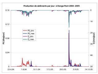
Fig. 2: Production de sédiments mesurée quotidiennement (SY\_meas) et simulée (SY\_sim) durant la période de calibrage
