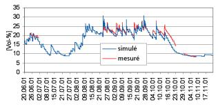
Fig. 2: Comparaison des humidités du sol simulée et mesurée pour l'horizon de surface du Lixisol (sol ferrugineux tropical lessivé) sous une végétation boisée dans l'Aguima supérieur
