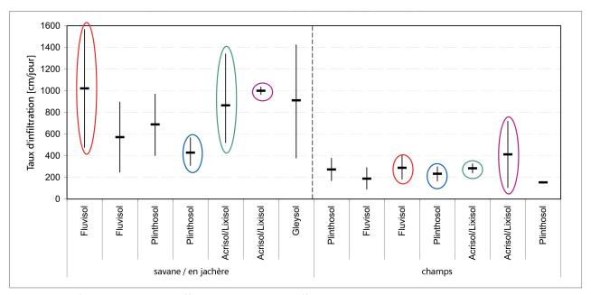
Fig. 2: Taux d'infiltration mesurés sur différents types de sols et différentes couvertures végétales; barre verticale: base = minimum, sommet = maximum, milieu = moyenne arithmétique, cercles: même parcelle
