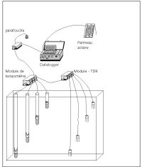
Fig. 2: Schéma d'installation des parcelles de mesure de l'eau du sol
