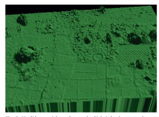
Fig. 5: Modèle numérique de terrain dérivé des images prises avec l'UAV. La précision de résolution en hauteur est de 7 cm. Cette figure couvre la même superficie que celle représentée à la Fig. 4.
