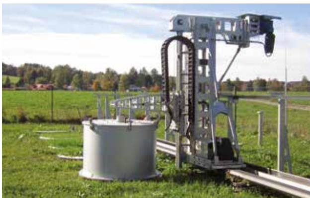
Abb. 4.1: Automatisches Treibhausgas-Messsystem am TERENO-Standort Rottenbuch. (Foto: Ralf Kiese, KIT IMK-IFU)
