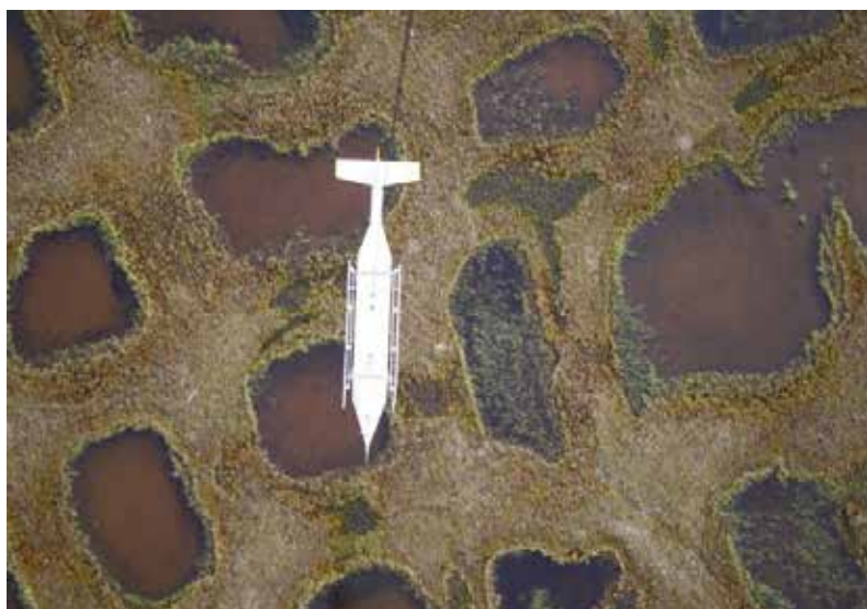
Abb. 3.4: Die Hubschrauberschleppsonde „Helipod“ während der Messung turbulenter Wärme- und CO 2 -Ströme über dem sibirischen Lena-Delta. (Foto: Torsten Sachs, GFZ)
