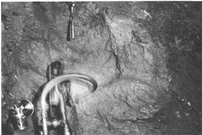
Abb. 3: Frisch angeschnittener Graphit vor Ort. In der Nähe der brennenden Grubenlampe zeigt der von der letzten Sprengung herrührende überall verbreitete Graphitstaub rötlichen Glanz, die Farbe im Blitzlicht ist bläulich. Abbau in der Zwingauer Mulde, Ostfeld, Kropfmühl, Teufe ca 100 m unter Oberfläche. Foto 1971.
