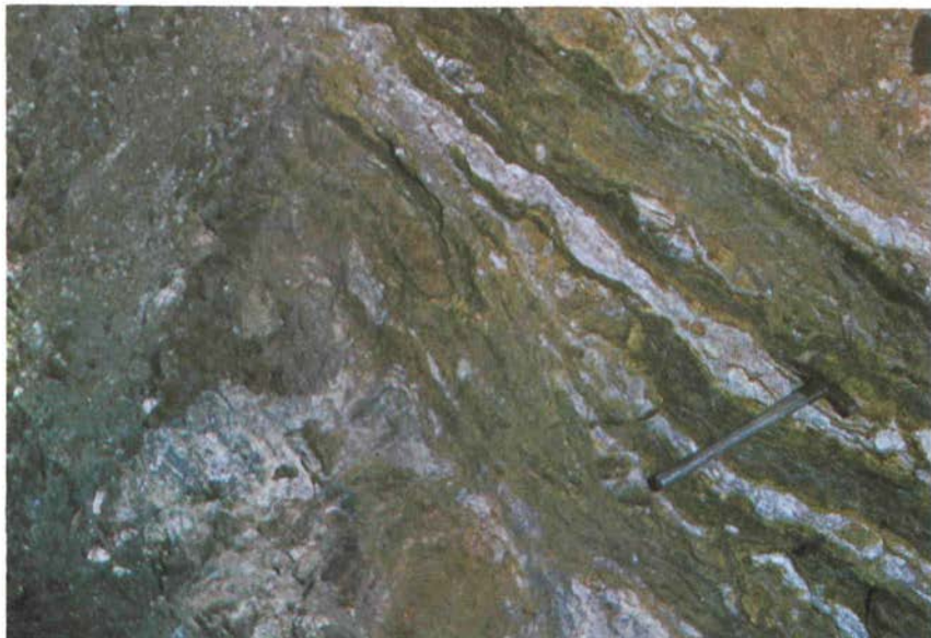
Abb. 5: Bändergneis (Plagioklasgneis) am Süden der Zwingauer Mulde mit schmalen Graphitlagen. Tektonische Schöllchen von Gneis sind bei der Verformung der parallellagigen Sedimente in das Graphitflöz eingeknetet worden. Ostfeld Kropfmühl, nahe dem Kringinger Verwurf, 60-m-Sohle. Beim Abhacken des Stoßes sind die Schlagmarken entstanden (dunkle Striche im Bild), weil der Pickel durch Graphit geschwärzt war.
