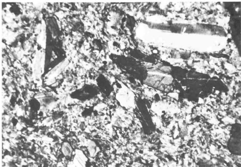
Abb. 7: Grundmasse eines Quarzdioritporphyrits mit Plagioklas-, Hornblende- und Biotiteinsprenglingen, nahe Kontakt. Schliff-Nr. 2947: Steinbruch Kirchstein. Gekreuzte Polarisatoren; Bildbreite 2,4 mm.
