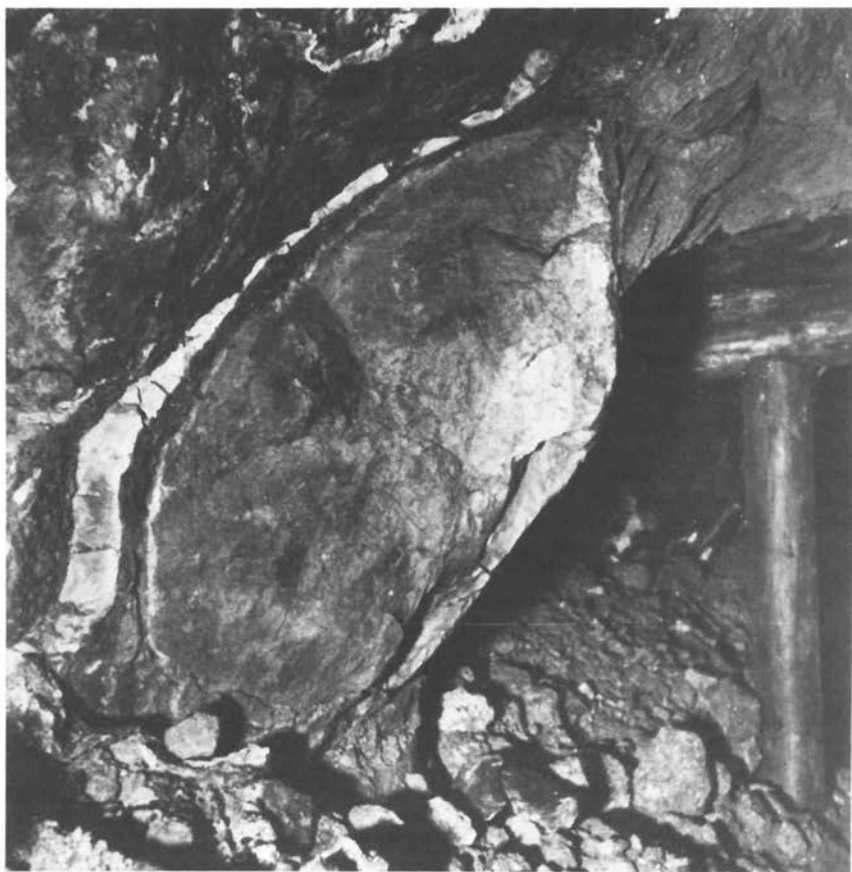
Abb. 2: Eiförmige Einlagerung eines pegmatitischen Gesteinskörpers im Graphitflöz, Weststrecke 2, 60 Meter Sohle im Zwingauer Schacht. Zwischen dem Hangenden des Graphits und dem Pegmatit ist ein Porphyritgang eingeschoben. Foto: SETTMACHER, 1958.
