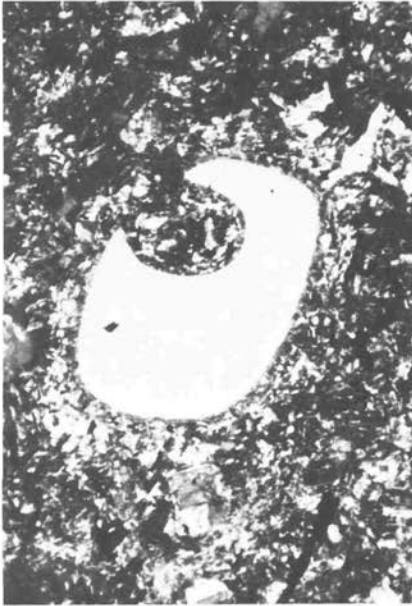
Abb. 13: Hochquarz-Einsprengling, gerundet und mit Resorptionsbucht. Schliff-Nr. 110 13: Steinbruch Grandior-Werk bei Steinerleinbach. Gekreuzte Polarisatoren; Bildbreite 3 mm.
