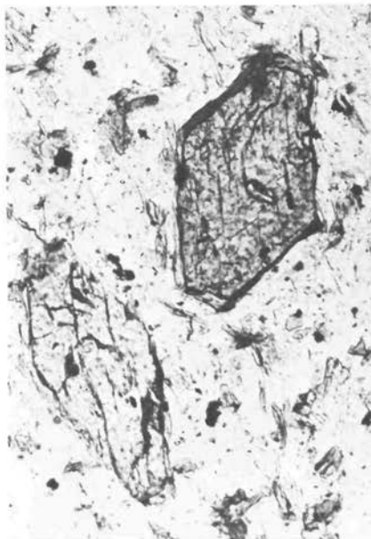
Abb. 11: Hornblendeinsprenglinge sind von Biotit umhüllt; Quarzdioritporphyrit Schliff-Nr. 2947; Steinbruch Grandior-Werk bei Steinerleinbach. Ein Polarisator; Bildbreite 0,4 mm.
