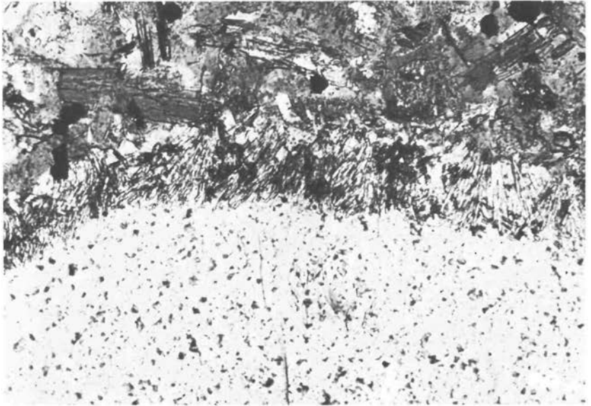
Abb. 16: Syplektitische Verwachsung von Quarz und Hornblendenadeln am Übergang von Grundmasse (oben) zum Quarzeinsprengling (unten). Schliff-Nr. 4971 (Dioritporphyrit): Steinbruch Grandior-Werk bei Steinerleinbach. Gekreuzte Polarisatoren; Bildbreite 0,5 mm.
