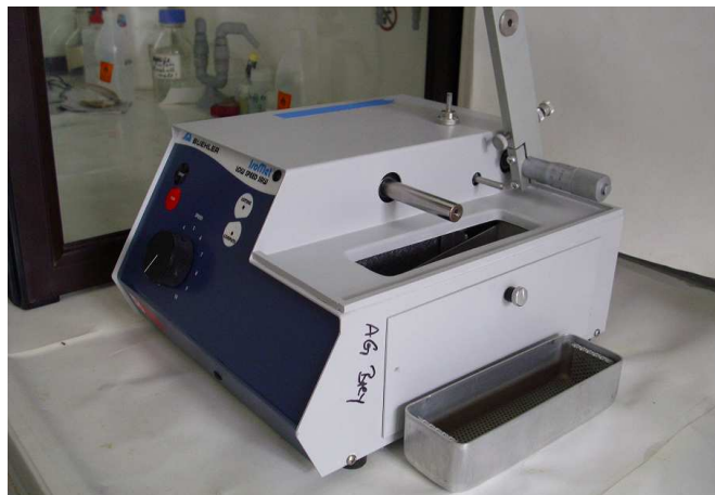
Abb. 7: Niedertourensäge Buehler Isomet™ Isocut ohne Sägeblatt.
