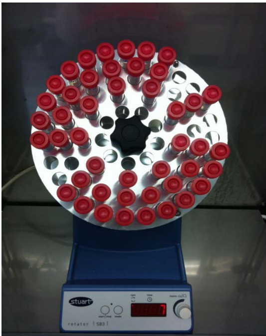
Abbildung 8: Rotator in Inkubationsschrank mit 45 Falcon Tubes
