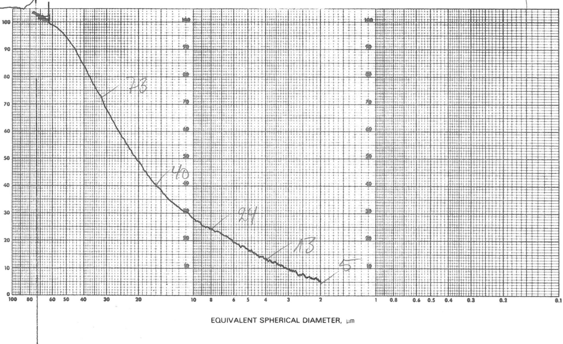
KORNGRÖßenVERTEILUNG DER FRAKTION  $\leq 63 \text{ } \mu\text{m}$
