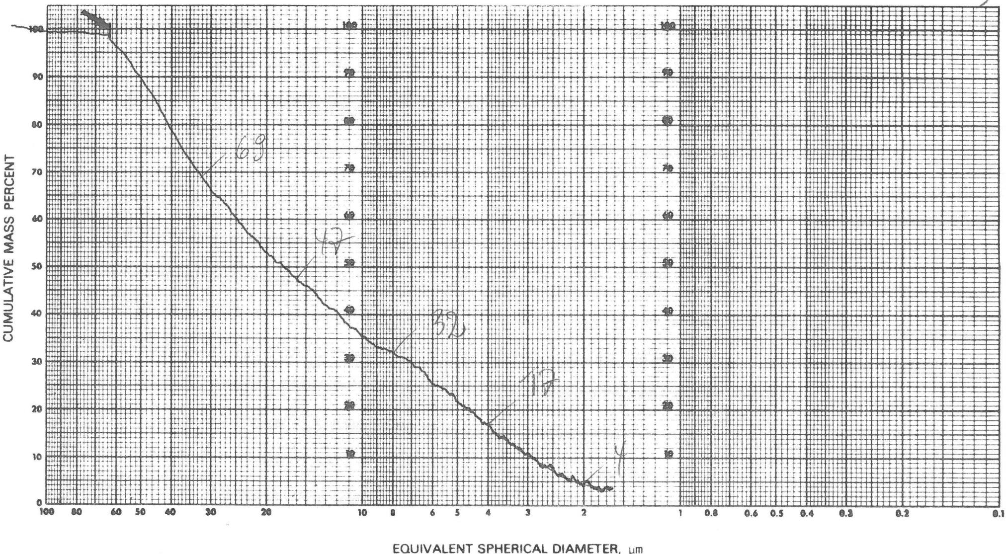
KORNGRÖßenVERTEILUNG DER FRAKTION  $\leq 63 \text{ } \mu\text{m}$
