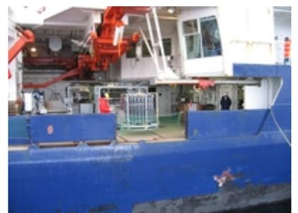
Die CTD zur Messung von Vertikalprofilen der Temperatur und des Salzgehalts sowie zur Wasserprobenahme geht zu Wasser. Foto: Charlotte Lohse
