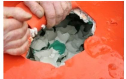
Die Innenansicht eines beschädigten Auftriebskörpers der Verankerung M7. Foto: Joel Sudre
