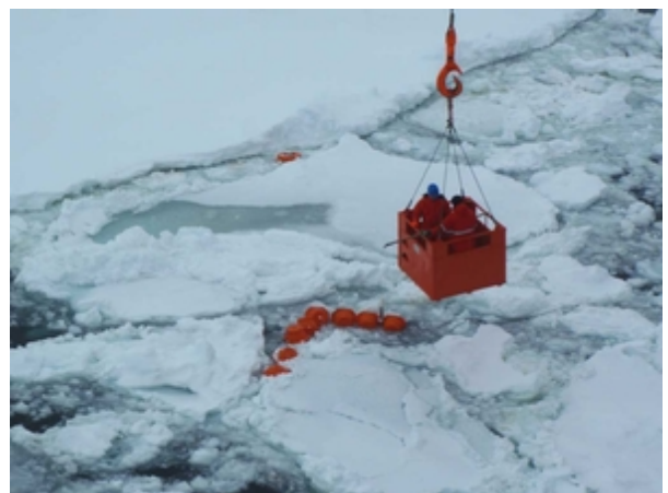
Aufnahme einer Verankerung im Eis mit Hilfe des Mammy-Chairs. (Foto: E. Fahrbach)
