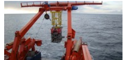
Bei ruhiger See wird das ROV QUEST mit Hilfe des A-Rahmen ausgesetzt.
