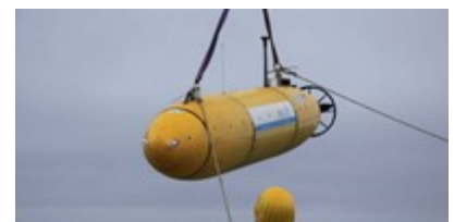
Das Aussetzen des Autonomous Underwater Vehicle wird schiffsseitig mit Halteleinen kontrolliert.
