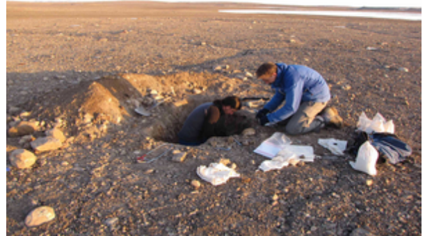
Schacht, um die Tiefe des Permafrostes zu bestimmen
