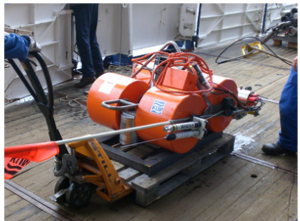
Ozeanbodenseismometer vor dem Aussetzen. Es ist auf einem Ankerahmen befestigt, der beim Wiederaufstieg auf dem Meeresboden bleibt. (Foto: Jürgen Gossler)
