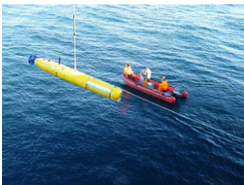
Das autonome Unterwasserfahrzeug (AUV - Autonomous Underwater Vehicle) des AWI wird nach einem Tauchgang in 500 m Tiefe unter Zuhilfenahme eines Schlauchbootes sicher an Bord geholt. (Foto: M. Klages)
