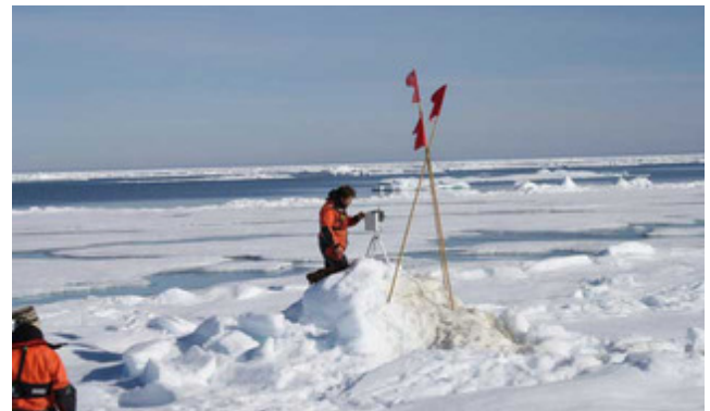
Vor dem Tauchgang des AUV unter das Meereis wurde unter Einsatz eines Bordhubschraubers ein GPS-Empfänger mit Funksender auf einer Eisscholle installiert. Mit diesem "ice tracker" konnten wir während des Tauchgangs die Eisdrift genau verfolgen und sicherstellen, dass das AUV nicht unter dem bewegenden Eis auftaucht. (Foto: Thorben Wulff, AWI)
