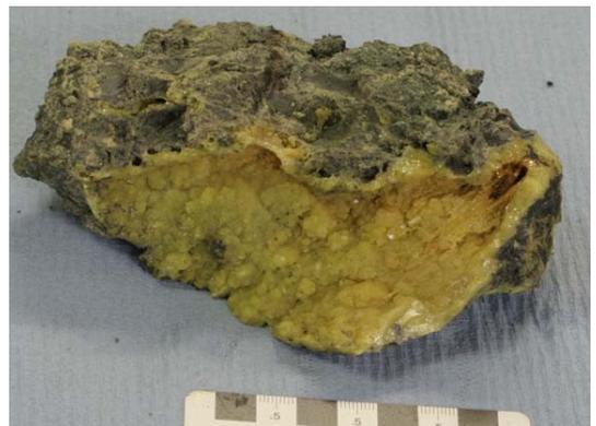
Der Einsatz eines TV-Greifens konnte zeigen das an diesem, bisher für inaktiv gehaltenen Seamount auch jetzt noch hydrothermale Aktivität festzustellen ist. Neben den an Bord gemessenen Temperaturen von bis zu 60°C in den Greifern und bis zu 42°C an der Basis der Schwerelotkerne konnten auch einige
