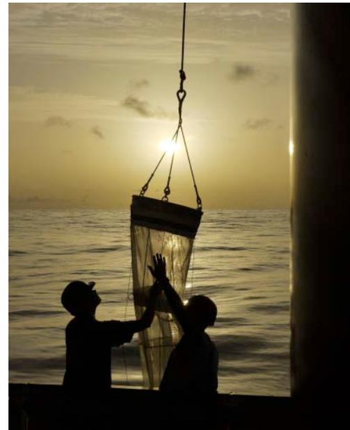
*Jeden Morgen wird das Planktonnetz auf 100m Tiefe gefiert und Probenmaterial für Experimente an Bord gesammelt*
