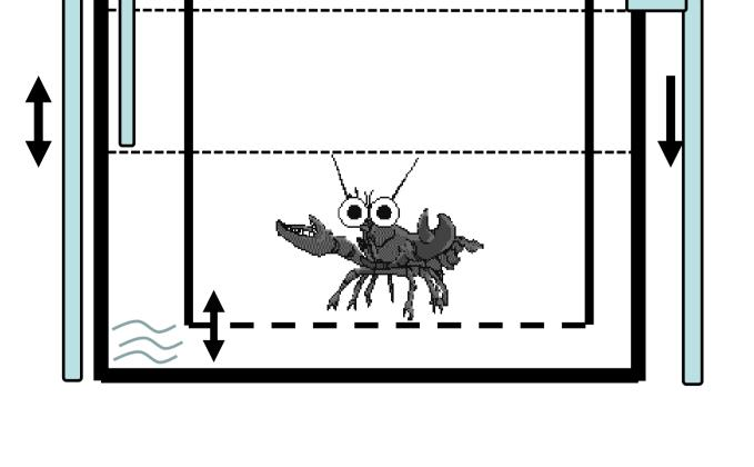
Diese periodische Änderung des Wasserstands wird automatisch über ein **Zeitschaltrelais**, welches die **Pumpen** an- und ausschaltet, gesteuert.
