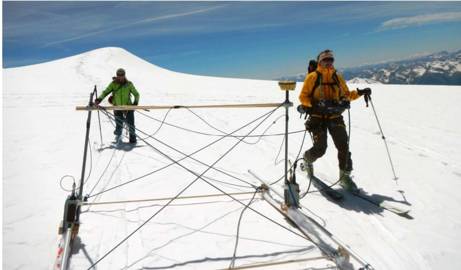
Abbildung 4: Das GPR der Firma GSSI in der verwendeten Konfiguration.
