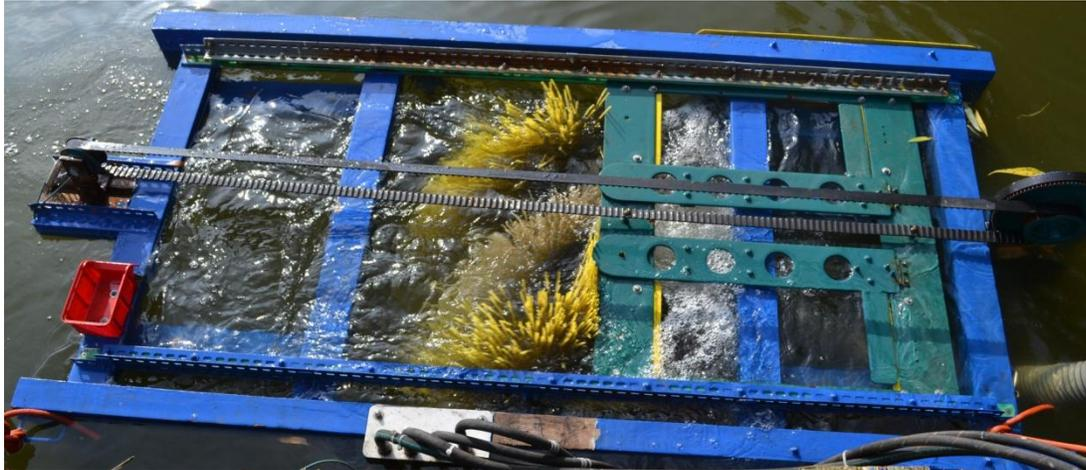
Abb. 14: Mobile Version der Bootswaschanlage der Firma „IPT UG“ zum Test des Bürstenreinigungssystems.
