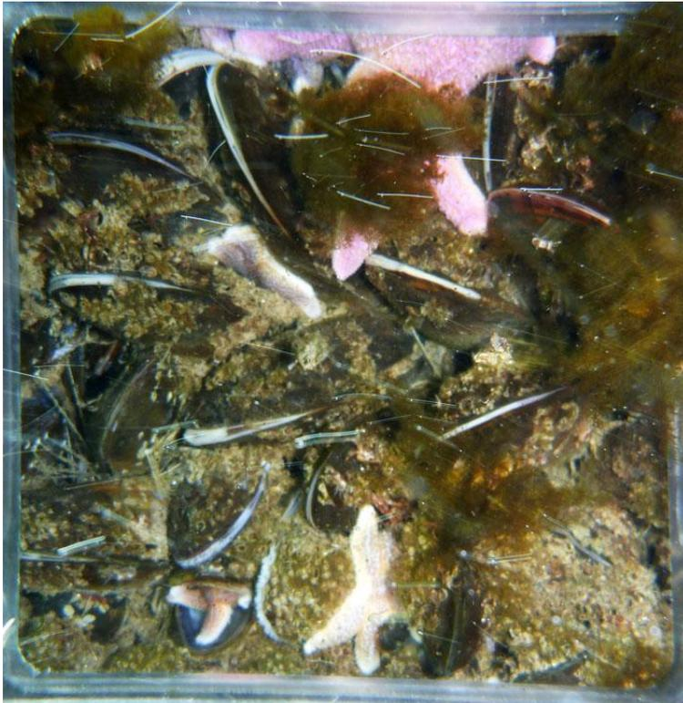
Abb. 6: Mariner Bewuchs an einer Jacketkonstruktion (Alpha Ventus) in 3m Tiefe
