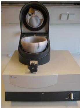
**Abbildung 1:** Verwendete Retschmühle RM 100
