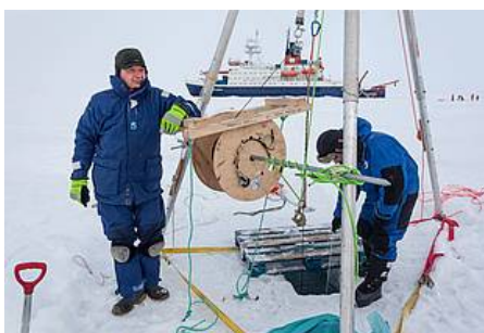
Abb. 4: Sergey und Nicolas bereiten das Ausbringen des 800 m langen Kabels einer Atmosphären-Eis-Ozean-Boje vor. Foto: Mario Hoppmann (Foto: Alfred Wegener Institut)
