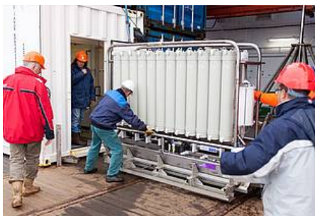
Abb. 2: Die Ultra-Clean-Rosette wird zum Einsatz aus dem Container gefahren. Foto: Mario Hoppmann (Foto: Alfred Wegener Institut)
