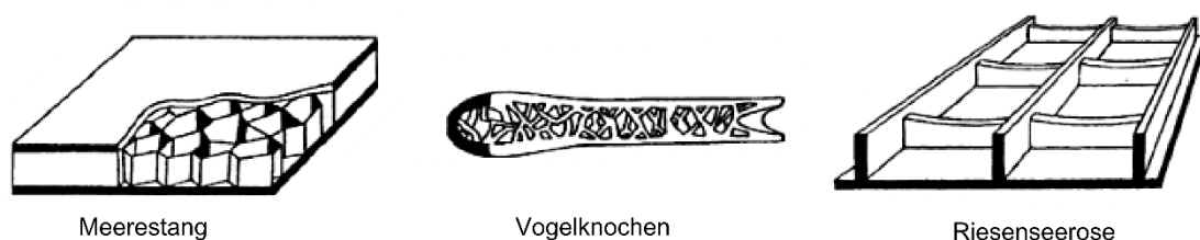
Abb. 2.3 Bionisch angewandte Versteifungsprinzipien (Tributsch, 1980). Abstrahiert dargestellt sind die biologischen Vorbilder Meerestang, Vogelknochen und Riesenseerose und deren wesentliche Eigenschaften, die als Inspiration für technische Flächenversteifungen gelten.
