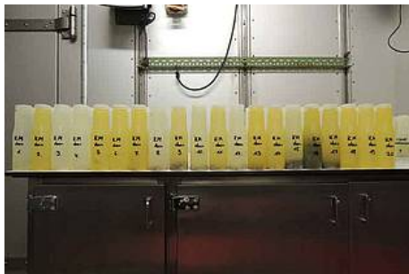
Abb. 9: Sinkstofffallenflaschen aus der Verankerung mit abgesunkenen Partikeln (Foto: Alfred-Wegener-Institut / D. Scholz)
