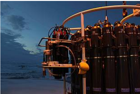
Abb. 5: Bestimmung eines kontinuierlichen Nitrat- und CO 2 -Profils durch ein Sensoren-Modul am Kranzwasserschöpfer (v. Oberfläche bis max. 550m Wassertiefe). (Foto: AWI / D. Scholz)
