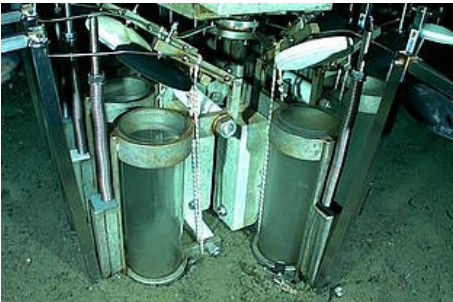
Abb. 8: Die Rohre des TV-MUC stecken im Meeresboden. (Foto: TV-MUC, AWI)
