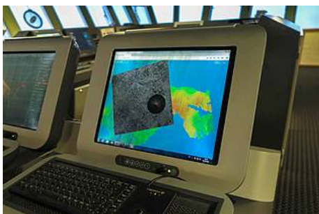
Abb. 4: IceGIS auf Brückenmonitor im Einsatz: Dargestellt wird das Brückenradar mit Schiffsposition, projiziert auf eine aktuelle Satellitenaufnahme sowie die Bodentopographie. (Foto: Alfred-Wegener-Institut / T. Krumpen)
