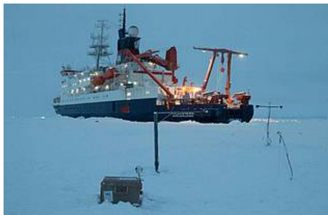
Abb. 3: Bojenstation bestehend aus einer Massenbilanzboje zur Messung der Eisdicke, Temperaturen und solarer Einstrahlung über und unter Meereis, und einer Schneeboje zur Messung der Schneedicke und Lufttemperatur. (Foto: Alfred-Wegener-Institut / M. Nicolaus)
