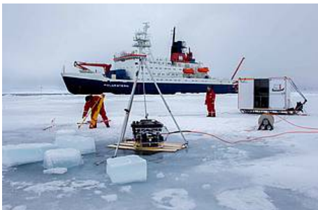
Abb. 2: Aufbau einer Eisstation mit dem ROV „Beast“. Das ROV wird durch das Loch im Eis zu Wasser gelassen und aus dem Kontrollstand, der auf Schlitten montiert ist, gesteuert. (Foto: Alfred-Wegener-Institut / M. Schiller)
