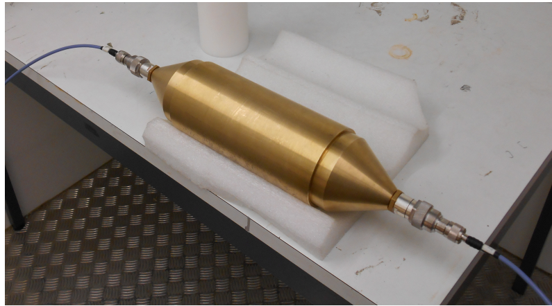
Abbildung 3.7: Koaxialzelle zusammgebaut in der Klimakammer: Links und rechts sind die beiden Koaxialkabel angeschlossen, die zum Netzwerkanalysator im Nebenraum führen, siehe Abb.3.8
